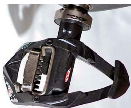
Pedály Time jsou charakteristické variabilitou nastavení úhlu vypnutí
