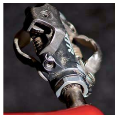
U pedálů je třeba čistit ústí osy, aby se nezanášela ložiska
