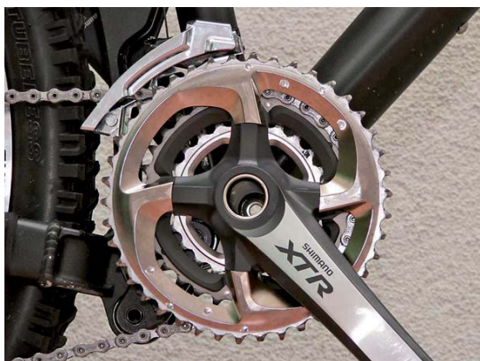
Zde se ještě nejedná o zcela novou generaci XTR, ale zatím pouze o designově upravenou dosavadní verzi. K velkému převodníku je zde uchycen plechový kryt, imitující tvar připravované novinky.
