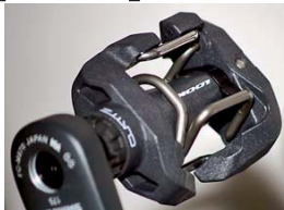
Pedály s pery jsou velmi odolné proti zanášení blátem
