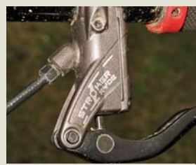
Na šroubu hadičky brzd Hayes je dobře vidět, že není dotažen k páce až na konec závitu, ale dva závity jsou venku z těla. Je to standard a někdy lze závít ještě větší díl. Takže žádnou paniku, pokud to nesákně, je to v pořádku.
