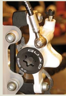
Díky Banjo uchycení ke třmenu nebo páce lze hadičku skoro libovolně natočit podle potřeby. Banjo je pouze kruhová průchodka s dvojitými těsnícími kroužky, kterou ve třmenu drží buď imbus nebo šroub s plochou hlavou. Některé značky do něho ještě implantují odvětrávací otvor krytý červíkem.
