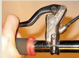
Brzdy Hayes Stroker mají pístek kolmo a čep výrazně vpředu, takže při pádu je poměrně na rámě. Páčka je kvůli lepší ergonomii prohnutá, ale při maximálním stisku je vidět, že jde hodně k řídítkům.
