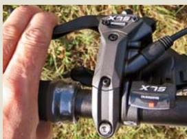
Shimano u většiny brzd přešlo na kolmé umístění pístku. Díky tomu odpadly problémy s kontaktem hadiček a páčka zabírá na řídítkách méně místa. Všimněte si výrazné vzdálenosti hlavního čepu páčky od řídítek.
