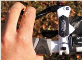
Novější verze brzd Tektro s kolmým pístkem má regulační kolečko vzdálenosti páčky, ale zároveň je páčka v polovině ergonomii prohnutá, aby byla zajištěna dostatečná ergonomie při stisku.
