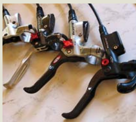
Na pákách Avia je vidět jejich výrazné odklonění směrem od řídítek. Čep s regulačním šroubem je pod hlavním čepem, ukrytý materiálem těla páky.
