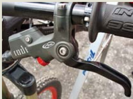
Brzdová páka Avid Code využívá pro uchycení páčky v hlavním těle průmyslová ložiska. Následkem je absolutní omezení vzniku vůle a maximálně citlivá páčka. Bohužel to s sebou nese i vyšší hmotnost. Toto provedení tak má opodstatnění pouze u sjezdové brzd.
