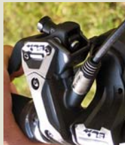
Shimano jde zcela jinou cestou a nemá tak u brzd SLX šroub ani jednoduchý mechanismus v páčce, ale trochu složitější objímku, která jde vnitřkem těla kolem páčky a dosedá na tělo až za ní.
