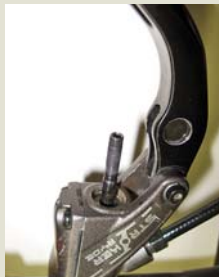
Naplo vyšroubovaný regulační šroub s kulovou hlavou umožní jednoduše demontovat páčku z těla ven. Pokud je závit čistý a páčka se povoluje, stačí ji takto povolit, šroub potřít tmelem a opět vše sestavit.
