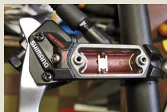
Nádobka brzdy Shimano je otevřená a do poloviny plná minerálního oleje, při odvodušování systému lze libovolně mačkat páčku, tedy pokud je spodní odvodušovací otvor na třmení uzavřen, a kapalina se v podstatě ani nehne. Jen z otvoru k pístku, který je ukrytý pod malým plíškem, se občas dostane do nádobky nějaká zbloudilá bublinka vzduchu.
