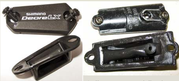
Starší model brzd Hayes má víčko nádobky uchycené dvojicí šroubů a gumová membrána je vyvedena otvorem ve víčku ven a otvor v membráně jistí plastový kolíček. Pro odvodušnění tak není třeba demontovat víčko. Prolis je zde dvojí, takže vzduchová kapsa je větší než u jiných brzd. Každý výrobce používá jiný tvar, nicméně princip je stejný.
