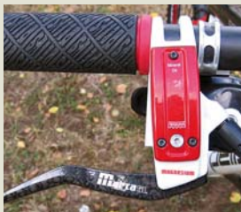
Na červeném víčku brzdy Magura je velmi dobře patrný malý otvor, který umožňuje regulovat objem vzduchu uvnitř.
