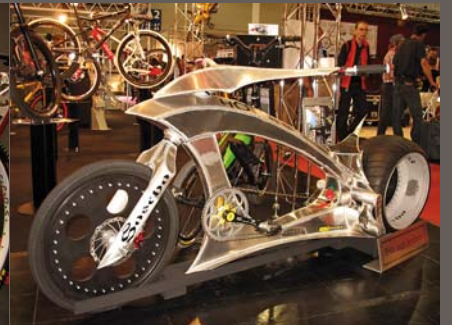
Původní řešení, kterými si německá novátorská značka Hot Chili získala srdce mnohých bikerů, se postupně rozšířila i mezi dalšími výrobci. A tak aby Hot Chili nezapadlo do zapomnění, ožívuje svou zacházející slávu aspoň touto pojezdnou „pálivou papričkou“ z duralu. Stroj je osazen bikovou planetovou převodovkou Rohloff, kotoučkovými Magura či ultrasírkou zadní pneumatikou ze závodní motorky.
