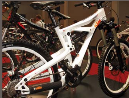
Naprostě nový design rámu KTM R.S.DH umožňuje změnu úhlu vidlice v rozmezí 64 až 66 stupňů díky samostatnému dílu hlavy. Nastavitelný je i zdvih jednočepového systému s přepákováním k tlumiči na 200 nebo 230 mm a také délka zadní stavby v rozmezí 440 až 460 mm. Dvojice podobně řešených freeridových strojů (na snímku) nabízí jen změnu zdvíhu a délky zadní stavby.
