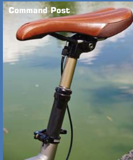
Specialized zcela přepracoval typy Stumpjumper FSR a Enduro, které dostaly nové rámy a vyšší zdvih. Součástí modelu Enduro bude rovnou teleskopická sedlovka Command Post.
