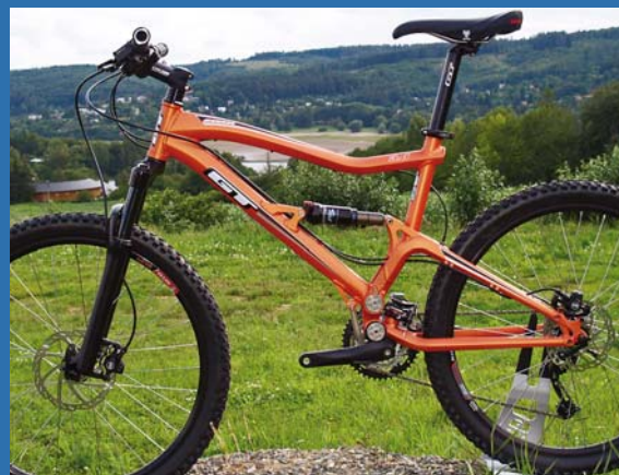
GT Sensor je nový model se 120mm zdvihem, jenž přináší přepracované zapouzdřené čepy systému i-link.
