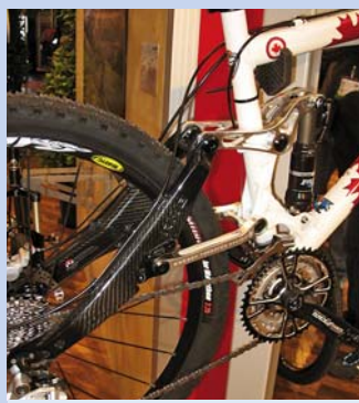
Asi jednoznačným zástupcem chodu osy po přímce je tento Rocky Mountain. U umístění ramen je jasné, že tah řetězce pružení zamýká a osa jde kolmo, nebo jen po kružnici velkého poloměru, přímo vzhůru.
