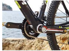
Nový standard BB 30 je postaven na duralové ose většího průměru 30mm, která snižuje hmotnost při vyšší tuhosti.
