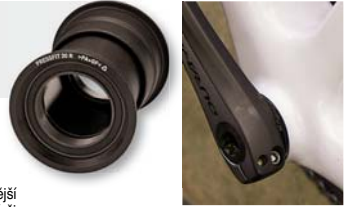
Nový systém Press Fit využívá lisované misek do rámu podobné, jako je tomu u hlavového složení.
