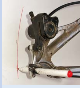
Jednoduchý test s pomocí fixy a velké čtvrtky. Bez laboratorii jsme pouhou demontáží tlumiče dokázali alespoň částečně zpočtybnit některé křivky, udávané výrobci.
