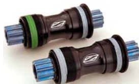
Klasikou je upevnění kliky na osu pomocí tšichrannu, jež využívají systémy ISIS, Octalink a také HollowTech II.
