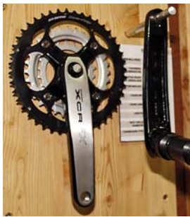
V současnosti najdeme na trhu zapouzdřené osy také s šestštrahným osazením, které zvyšuje životnost při zachování menšího průměru zapouzdřeného středu.
