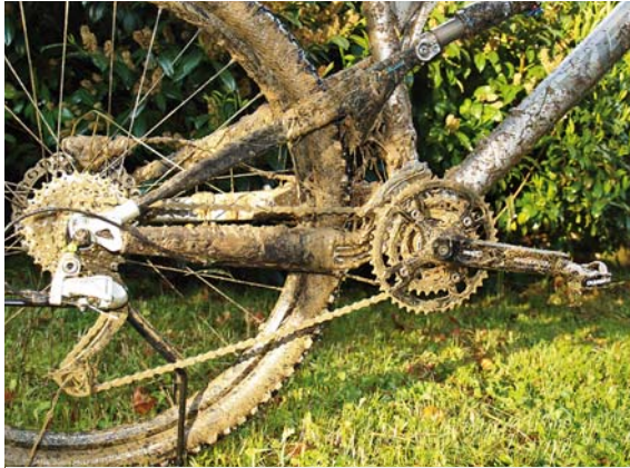
Ložiska středového složení jsou vystavena nečistotám, a tak devadesát procent všech zvuků, lupání a vrzání v rámu, pochází právě odsud.
