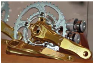
V minulosti velmi rozšířené čtyřhranné uchycení klik na osu bylo málo odolné a je dobré, že je dnes již minulostí.
