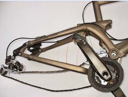
Jednoduchý test s pomocí fixy a velké čtvrtky. Bez laboratorii jsme pouhou demontáží tlumiče dokázali alespoň částečně zpočtybnit některé křivky, udávané výrobci.
