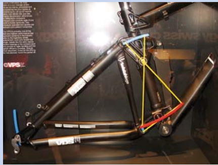
Švýcarská značka BMC dokonce prezentuje část svého rámu v virtuálním čepem, aby pomocí křivky ukázala, jak se systém pohybuje. Trajektorie pohybu virtuálního čepu je znázorněna červeně.
