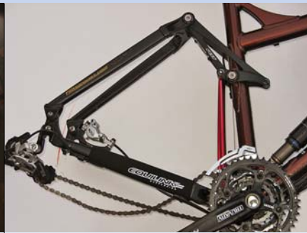
Felt využívá spojení obou vahadel zadní stavby taktéž Equilink. To by mělo chodit obou vzájemně sladě. Několik modifikací systému využívá jak čep Horst Link, tak jednodušší zadní stavbu.
