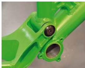
Pro odstranění nežádoucích zvuků je třeba vymontovat středové složení a vyčistit a promazat závity. Od věci nebude u nových rámu závity pročištit závítovníkem.
