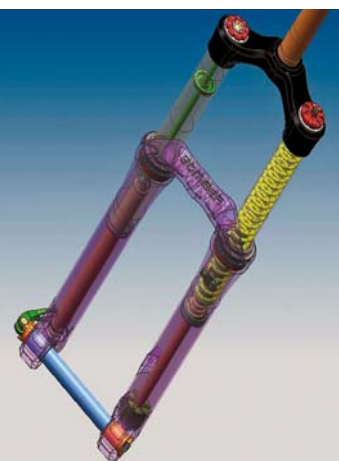
Přepracovány jsou vnitřnosti, pouzdra, pevná osa i ovladače.
