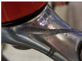
Tato nenápadná rýha má hloubku 2 mm, což může časem na korunkách některých lehkých vidlic vést k poškození konstrukce. Vždy je totiž počítáno s určitou tloušťkou materiálu v daném místě, a pokud ta se výrazně sníží, může dojít k prasknutí.
