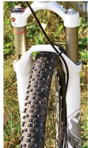
Naprostý ideál ve vedení hadičky. Vnitřní strana vidlice, na můstku přední úchyt pro dokonalé usazení a ze zadu zářez pro jisté dosezení stahovacího pásku. Tolik let to trvalo, než to přišlo s novým sidem.
