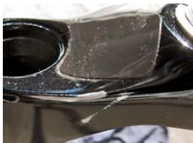
Zde se ochranná samolepka minula účinkem, hadička s ní takřka nepřišla do kontaktu, ale brousila hranu korunky.
