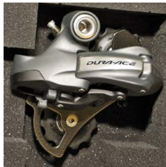
Jeden z prototypů a finální verze přehazovačky. Laborovalo se nejen s materiálem ramínka, u něhož nakonec zvítězil karbon, ale rovněž s umístěním vratné vlnuté pružiny. Hlavní čepy měniče jsou titanové.
