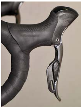
Podle vzhledu páky Dual Control se skoro nedá poznat, že se nejedná o mechanickou verzi ovládanou lankou.
