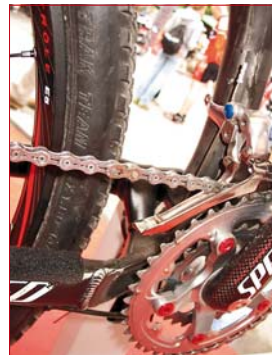
K silničním klikám FACT pasuje přesmykáč Dura-Ace i odlehčený řetěz KMC. Všimněte si údaje 1,8 o šířce pláště.
