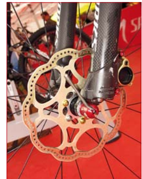
Kotouče s uchycením maximálně odlehčeným, titanové táhlo a páčka rychloupínáku a samozřejmě lepené paky na karbonových nohou vidlice Pace s titanovou korunkou. K tomu i nejlehčí brzdy Magura Marta SL.
