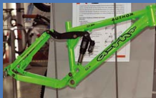
Prvním rámem, jenž vznikl díky spolupráci s libereckou Technickou univerzitou, je enduro rám A-rh se 150mm zdvihem
