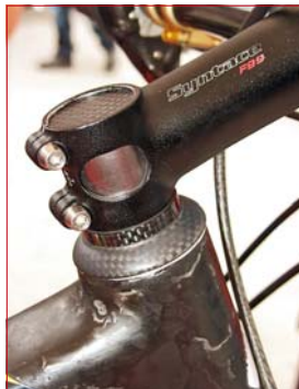
Ačkoli by bylo možné použít karbonový představec, zde má Christoph raději jistotu v duralu. Karbonová krytka hlavového složení, stejně jako víčko představce, jsou už jen kvůli hmotnosti.
