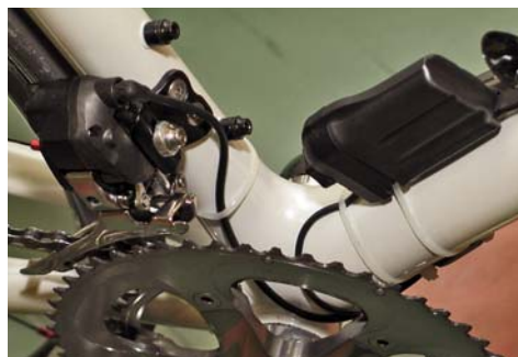
K akumulátoru, jenž se umísťuje pod přesmykač na spodní trubku rámu, dostanete i originální nabíječku. Pokud vám dojdou baterky uprostřed tréninku, můžete někde u cesty vřezbat třeba spodní díl akurtačky.
