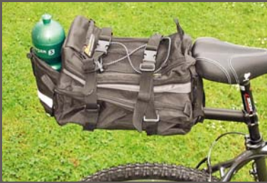
Brašna na sedlovkový nosič má obsah kolem sedmi litrů, nosnost je dána hlavně pevností sedlovky. Omezení jízdyce při posunutí těžších vzad záleží hlavně na výšce a vysunutí brašny vůči sedlovce.
