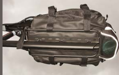
Uchytní většiny brašen k nosiči je řešeno stahovacími páskami na suchý zip. Upevnění a demontáž jsou tedy trochu pracnější. Moderní řešení využívají plastovou desku s „click“ systémem“, kde všechno jistě jediná pojistka.
