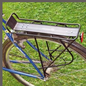
Nosič pro namontování napravo k rámu by měl mít dostatečně odolnou konstrukci. Prohnuté boční výtzyhy nejen zpevňují konstrukci, ale také poskytnou lepší oporu bočním stěnám brašen.
