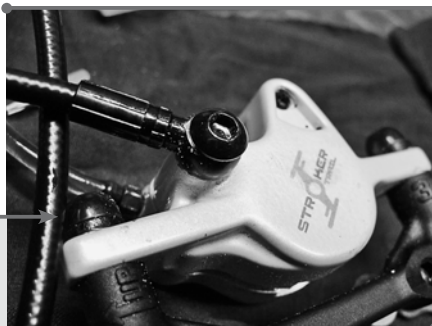
Banjo uchycení hadičky sice umožňuje její natočení podle pozice třmene na rámu, ovšem při silnějším kontaktu s botou nebo větví jej můžeme vychýlit a povolit.
