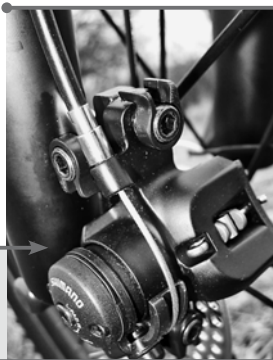
Proti povolování šroubů třmene a adaptéru bojuje Shimano nasazením plastových pojistek. Všimněte si dostatečné rezervy lanka pro zajištění bezpečného kroku táhla.
