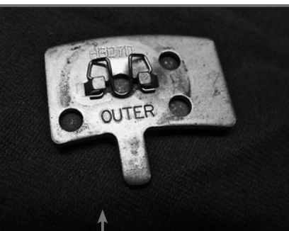
Někteří výrobci mají obě destičky totožné a zaměnitelné, jiní už raději informují, která je vnitřní a která vnější.
