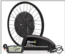
Kanadský BionX dodává zadní nábojový motor obrovského průměru, ovšem dráty jsou uchycené kolem něho, co nejlépe osy kola. Tenhle motor na 48 voltů má schopnost rekuperace, tedy brzdění motorem za jízdy z kopce, kdy se částečně dobijí baterie a prodlouží tím dojezd až o 15 %.
