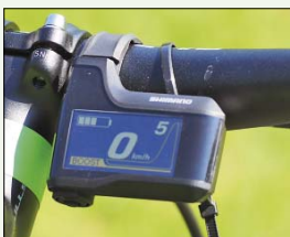
Shimano nejenže svojí sadu E8000 umí kombinovat s elektronickým řízením Di2, ale má od něj také malý displej, jenž zobrazuje všechny základní funkce pohonu.
