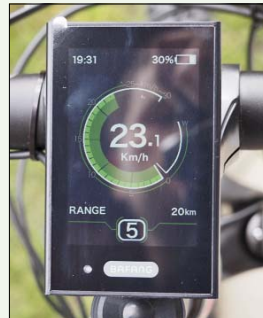
Nový displej značky Bafang je krásně přehledný a až překonaně nápadně zobrazuje uprostřed okamžitou rychlost. Nicméně umí propočítávat aktuální dojezd, což je důležité, ale pozor na aktuální zobrazení v extréměch – může kolísat i na neuwěřitelných hodnotách, aby se s příbývajícím nájazdem postupně zpřiměovalo, což je společný princip většiny pohonů.
