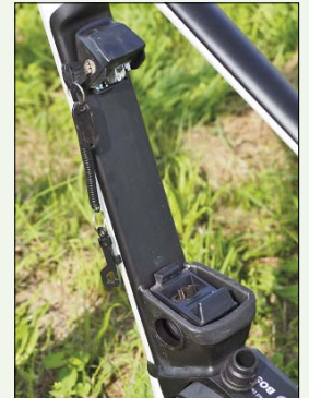
Baterie u nejnižších elektrokolech je v nosiči, za sedlovkou nebo má samostatný držák v otvorech pro košík na bido, ale moderní kola mají speciálně upravenou spodní trubku. Nahoře je integrován zámek baterie, dole konektory vysupující z prostoru s řídicí jednotkou, vše zakomponované, částečně integrované.
