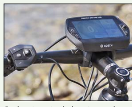
Steže lze mít namísto displeje svůj smartphone s sadou aplikací, ale nejpracovnější je displej Bosch Nyon, jenž je schopen kromě všech cyklistických „elektro“ funkcí zobrazit i fitness hodnoty nebo trasu dle navigace a možného dojezdu.
