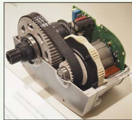
Umístit motoru Brose funguje soustava ozubených plastových koleček a centrální řemen. Přívod tohoto motoru je přívod v automobilovém servu řízení a výrobce udává 90Nm točivý moment.
