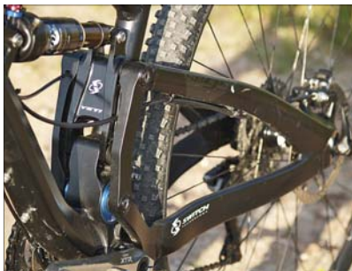
Vylepšené provedení Switch závěsu na 29" modelu SB-95 má více excentrický čep otáčení, ale zadní stavba je symetrická a přepákování sedí mezi oběma rameny.
