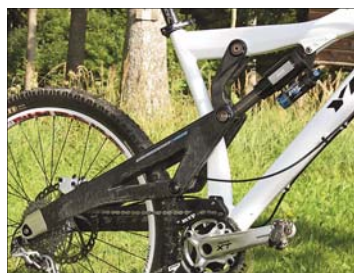
Tak tenhle prototyp jsme měli to šesti testovat na vlastní kůži a asymetrické provedení masivní karbonové zadní stavby vypadalo dost šilně. Hlubokému zářivku nelichotila menší tuhost celku, a nakonec se tenhle kousek neujal.
