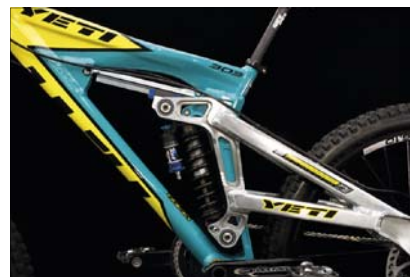
Sjezdová zbraň 303 nesla zadní stavbu na speciálních kolejničích, po kterých klouzala nahoru a vpřed, bohužel toto řešení se neuchytlo na dlouho, a u sjezdáků to vyhněly klasické čep.
