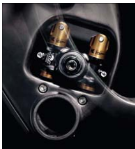
Dvojice pístů je v rámu umístěna v jakémsi speciálním okně nad středovým pouzdem, které bylo asi snažší vytvořit z karbonu, protože duralový rám s touto výmožností bychom v kolekci hledali marně.
