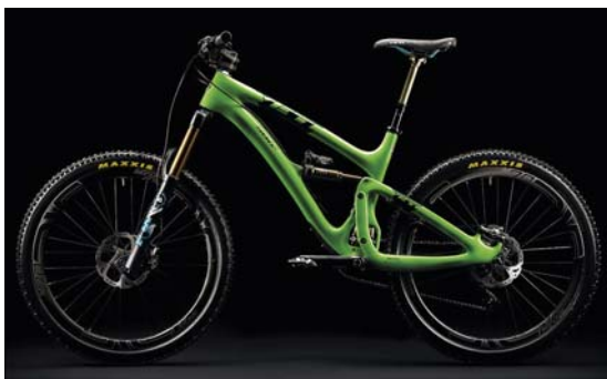
Tohle je dokonalý stroj. Yeti SB-6 s technologií Switch Infinity, zdvihem 152 mm a hmotností 2,67 kg. Jared Graves má opravdu perfektního spojence pro světové enduro.
