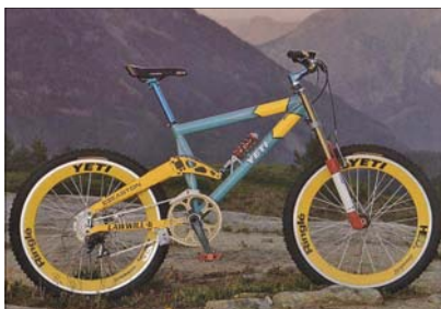
Tenble design má Yeti společný s koly Schwinn a stojí za ním Merit Lawwill, který navrhl tenble systém zadní stavby. Tažný tlumič tohoto modelu byl hodně populární díky možnosti nasadit na něj jako ochranu proti blátu kondom.
