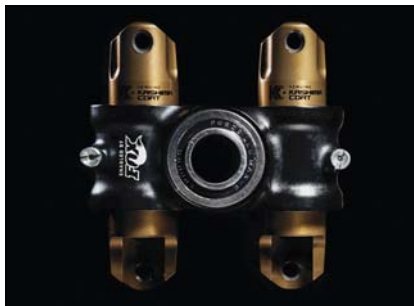
Toto je srdce nejmodernějšího řešení Switch Infinity, dvojice kluzných pístů, na nichž se směrem nahoru a dolů pohybuje zadní stavba, v závislosti na fízi zdvihu. Tohle nahrazuje excentr Switch, ale standardní zapouzdržené ložisko pro otáčení zadního trojúhelníku nechbí ani v tomto případě.
