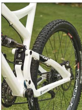
Opavdu neskutečné funkční technologie Switch na modelu SB-66 přinesla supercitlivé odpružení, tuhost a vynikající kinematiku zadní stavby. Zadní stavba je zde ještě asymetrická a hlavní čep se točí v excentru.
