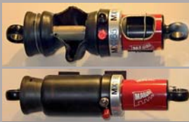
Pevný plášť tlumiče Magura je nahrazen gumovým obalem, jehož pevnost je nastavena podle jednotlivých systémů odpružení. Uvnitř tlumiče nekuluje olej, ale pouze vzduch.
