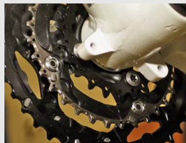
Odvrtané převodníky klik SLX připomínají domácí tuning. Klasické imbusové šroubky byly nahrazeny osazením Torx. Zásadní je však přepracování prostředního převodníku, jenž má ocelový základ a karbonové boční zpevnění. Tedy další z technologií, které se postupně přesunují z nejvyšších sad na ty cenově dostupnější.
