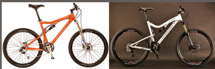
Nová verze Blur LT (vpravo) má oproti stávajícímu modelu vyšší zdvih 140mm a celkově modernější vzhled se spoustou vylepšení.
