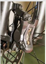
Brzdový třmen SLX je pouze odlehčenou verzí dosavadního modelu. Lakované tělo se tváří téměř jako jednodílné, ale je spojeno ze dvou částí. Jednodílný třmen tak i nadále zůstává výsadou pouze prestižních sad značek.
