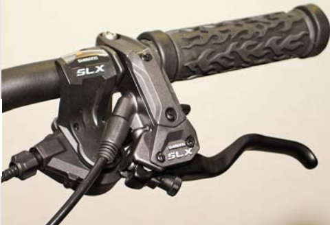
Konstrukce brzdové páky i řazení nové sady SLX vychází z vyšších modelů Deore XT a XTR. Umístění expanzní nádobky i vyevedení hadičky maximálně šetří prostor na řídítkách. Ideálně přístupný je šroubek pro seřizení vzdálenosti páky od gripu.
