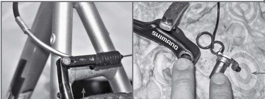
Napojení bowdenu kovovým „výfukem“ bývá nejčastějším místem zatuhnutí lanka.
