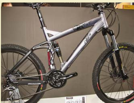
Značka Felt nejsou jen plážové cruisery těch nejelegantnějších designů, nebo bikosová kola. Felt umí i pěkné silničky, kola pro XC nebo celoodpružené biky se systémem Equi-link, který kombinuje virtuálním pivotem zavěšenou zadní stavbu s ještě jedním čepem navíc. Zní to dost divoce, ale funguje to na několika úrovních zdvihů.
