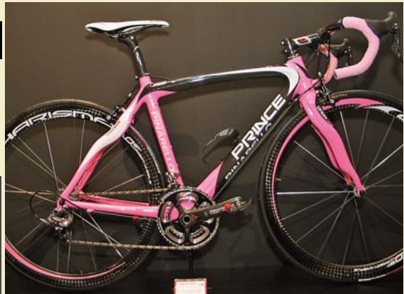
Pinarello představilo nový topmodel se staronovým názvem Prince. Ten sází na kombinaci nízké váhy rámu (pod 900 gramů) s maximální tuhostí, což zajistil karbon s označením 50HM1K s vysokou hustotou vláken. Monokokový rám využívá spodní ložisko hlavy s rozměrem 1 1/4", karbonové patky, asymetrickou zadní stavbu a nevsedně tvarovanou hlavovou trubku.
