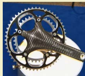
Byli jsme pravděpodobně jedini novináři, kteří drželi v ruce prototyp karbonových klik Shimano Dura-Ace, neboť jinak byly umístěny pod pevným průhledným poklopem. Díky zpevňující vnitřní kleci z duralu by měly kliky nabídnout stejnou pevnost jako duralové provedení, a to při snížení hmotnosti. Odlehčené převodníky již mají zcela otevřenou konstrukci.
