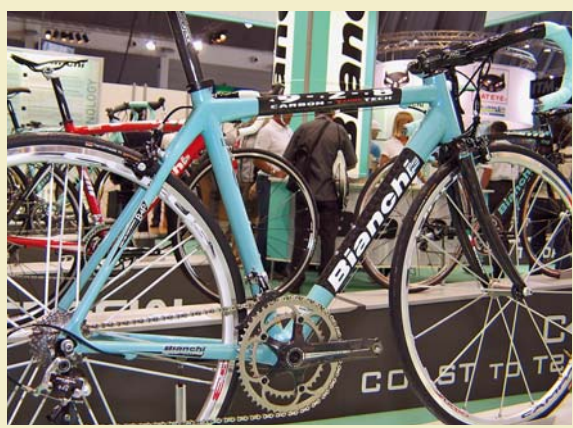
Bianchi zcela přepracovalo model 928 Carbon (na snímku), který nově využívá technologii nazvanou „Tube to Tube“, kdy jsou jednotlivé trubky rámu spojovány většími opláštěním. Novinkou je také celoodpružený XC bike Camos Carbon s „virtuálním čepem“ a za sedlovou trubkou naležato umístěným tlumičem. Nový karbonový rám má také hard tail série Oetzi.
