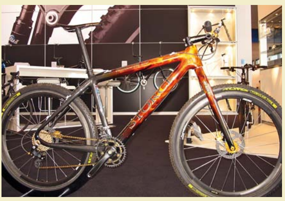
Storck je králem tuningu a nízké hmotnosti. Nový celokarbonový rám Rebelion doplnily karbonové kotočce, stejně jako jsme fotili na Gardě, ovšem zde s jinou brzdou. Nepřehlédnutelné jsou také karbonové kliky Tune, duralové pastorky, oba měniče z karbonu a galusky Tufo. Tato česká značka mimo jiné představila i nový výrazně hrubší model bikové galusky.
