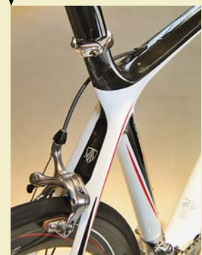
Po maximálním zvýšení tuhosti rámu jde i Trek, což dokládá úplně nový silniční rám Madone s mohutnou partií okolo středů. Spodní ložisko hlavového složení má rozměr 1,5", nahoře je klasika 1 1/8". Atypická je plochá monostay vzpěra a provedení sedlovky. Ta je zvenčí nasunuta na prodlouženou sedlovou trubku a utužena širokou leštěnou objímku.
