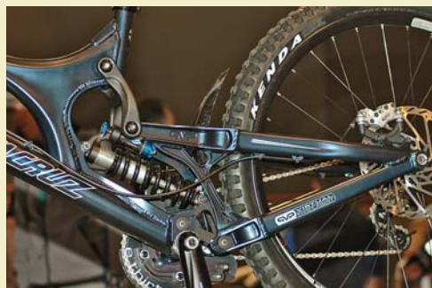
Santa Cruz v poslední době inovuje snad všechny své modely a přišla řada i na pevný XC stroj Chameleon, jenž byl zesílen a upraven pro možnost použití vidlice se zdvihem 160mm i přetvoření na singlespeed. Sjezdový model V10 (na snímku) prošel odtučňovací kúrou. Ztratil skoro kilo váhy, mimo jiné i díky karbonovému vahadlu. Zdvih dosahuje hodnoty 254mm.
