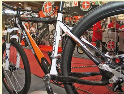
Mongoose Meteore, coby závodní hardtail, se ve verzi Ultimate s celokarbonovým rámem posunuje opět výrazně výš. Jeho rám s nekonvenčně tvarovanou spodní a sedlovou trubkou a především s nepřehlédnutelnými duralovými příšrobouvanými patkami nabídne závodníkovi nekompromisní přenos síly.
