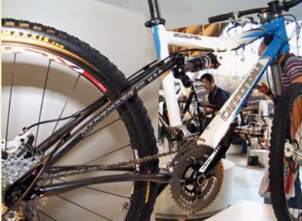
Cannondale výrazně přepracoval úspěšný celoodpružený XC model Scalpel. Idea v podobě pružných spodních ramen zůstala zachována, zkrácen byl rozvor a tlumič je nově umístěn pod horní trubkou. Tím se zvýšil zdvih na 8,5 cm a zároveň vzrostla citlivost systému. Novinkou je také silniční model SuperSix s celokarbonovým rámem.
