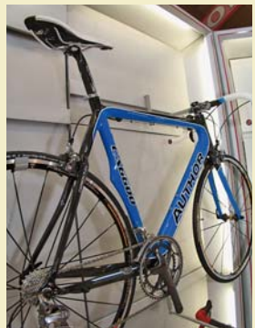
Author připravil úplně nové karbonové rámy pro nejvyšší silniční modely, které by měly nabídnout ještě vyšší tuhost. Atraktivitu zvýšily i hodně vylepšené designy. Hardtaily Introvert a Master dostanou také karbonové monokokové rámy, charakterizuje je hmotnost 1250 gramů, zcela rovné sedlové vzpěry bez využití monostay a vnitřní vedení k zadní brzdě.
