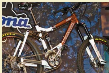
Santa Cruz v poslední době inovuje snad všechny své modely a přišla řada i na pevný XC stroj Chameleon, jenž byl zesílen a upraven pro možnost použití vidlice se zdvihem 160mm i přetvoření na singlespeed. Sjezdový model V10 (na snímku) prošel odtučňovací kúrou. Ztratil skoro kilo váhy, mimo jiné i díky karbonovému vahadlu. Zdvih dosahuje hodnoty 254mm.
