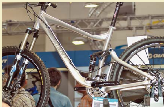
Giant představil zatím nejlehčí provedení svého systému Maestro, jenž zdárně dokáže zamezit propružování při šlapání. Spodní trubka je více prohnutá, takže už není třeba v ní vytvářet původní otvor. Současné provedení zůstane zachováno ve verzi X, tedy pro extrémnější nasazení, novější, odlehčené a zprohýbané rámy Trance a Reign jsou pak určeny pro „jemnější“ použití při XC, maratónu a all mountain.
