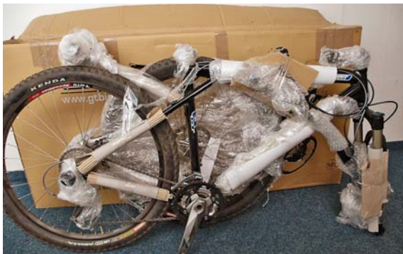
Pokud kolo balíme do krabice, je potřeba sejmout přední kolo, pedály i řídítka
