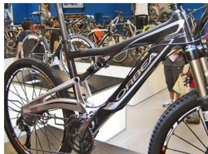
Kompletní odpružení v co nejjednodušším a nejlehčím provedení je pro cross-country a maratony jistě výhodou, rozhodně ale není nepostradatelné. Pokud se pro něj již rozhodnete, zaměřte se také na torzní tuhost rámu.
