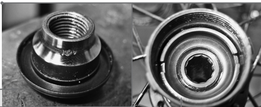
U zadního náboje je důležité dotažení ořechu, pravidelně vyjetá kuličková dráha nevdá, nesmí ale mít výraznější nerovnosti.
