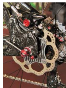
Kotoučové brzdy většinou znamenají vyšší účinnost, ani ony však nejsou nepostradatelné. Cesta co nejnižší hmotnosti nemusí být v případě kotoučovek ta nejlepší. Jezdíte-li běžně cross-country, třeba i v závodní podobě, kvalitní V-brzdy jsou i dnes většinou dostačující.
