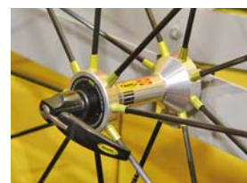
Z karbonu jsou dnes nejen rátky či pláště nábojů, ale i výplety kol pro závodní použití. Nicméně to, co je konstruováno pro sedmdesátikilového závodníka, pravděpodobně nebude tím pravým pro hobby cyklistu vážícího metrů.
