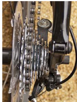
Takovéto plastové „hrabičky“ už dnes nejsou často k vidění, ale ve velkém bahnu také pomůžou. Předejdou přeskakování řetězu na malých pastorkách, neboť stále čistí prostor mezi nimi.
