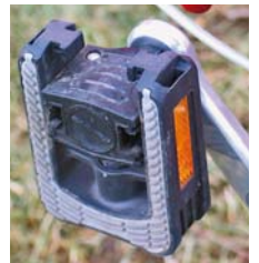
Sklápecí pedály s plastovým tělem jsou nedílnou součástí cestovních skládaček. Pro sportovní skládací kola je možné zvolit nášlapné pedály MKS, jejichž dvoudílná osa umožňuje jednoduché vysunutí, aniž by bylo nutné vyšroubovat nosník z kliky.
