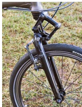
U skládacích 20" kol je o něco složitější vyřešení předního odpružení. Nejčastěji bývají použity systémy vycházející z paralelogramu. Pokud by se tato vidlice otočila předkem dozadu, pak by téměř z oka vypadla legendárnímu modelům AMP.
