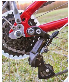
Často jsou využívány i konstrukčně nestandardní přehazovačky uchycené těsně před patkou, jejichž výhodou je menší náclhlynost na poškození. Nejsou totiž tak vzdáleny od osy kola a zadní stavba rámu je dostatečně chráněná.
