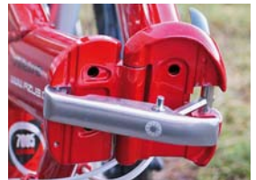
Pantový mechanismus nejčastěji používaný u cestovních skládacích kol. Jak je vidět, vše je maximálně bytelné a jednoduše ovladatelné.
