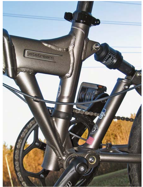
Současné skládačky jsou technicky vyspělejšími koly, často s moderními profilacemi trubek. Odpružený model Dahon JetStream využívá jednoduché zavěšení zadní stavby. Na snímku je dobře patrná kompletně průchozí sedlová trubka, sloužící k úplnému zasunutí sedla.
