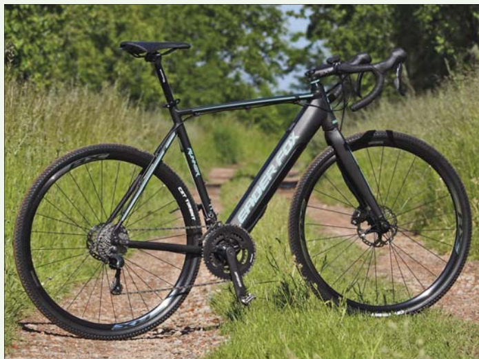
Ai už silniční, nebo v tomto případě gravel elektrokola, nemusí mít vždy zadní či středový pohon. Model na snímku má pohon Fazua, který do rámu naprosto integruje pouze převodovku s klikami a motor i baterie se pak vkládají do spodní trubky jako jeden celek, pohánějící převodovku a kliky přes adaptér. Na tohle řešení sází i řada renomovaných výrobců silničních elektrokol.
