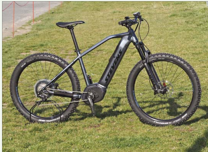
Plusková sedmadvacítkový hardtail je trochu osobitá kategorie (zde šlapá motor Bosch s malým převodníkem) nabízející komfort díky tlumení objemných pláštů. Ty pak výrazně navýšují i jistotu v terénu, ale na silnici už to není tak optimální svezení. Přesto je to dobrá terénní e-alternativa pro ty, kdo holtají rozbitému povrchu, ale nechťejí kompletní odpružení.
