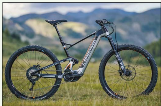
Integrace baterií do rámu sice vyžaduje jejich šitřlejší tvar a zdvouení stěn rámových trubek, ale kola s plně integrovanou baterií se na první pohled už moc neliší od těch bez motoru. Ať už je baterie vkládána do spodní trubky shora či zespodu, případně otvorem z boku, vždy je to hlavně kvůli designu, ne pro nějaké lepší vlastnosti celého kola.
