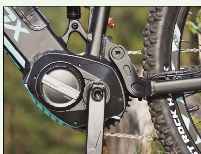
Středové pohony jsou stále kompaktnější a menší, aniž by to bylo na úkor výkonu. Toto řešení dostává maximum hmotnosti do těžiště kola, takže je nejlepší nejen z hlediska ovladatelnosti celku, ale i co se výkonu týká. Kratcíci moment se pohybuje v rozmezí 60–120 Nm, takže při správném nastavení na velké pastorky je vždy k dispozici hodně velká síla.
