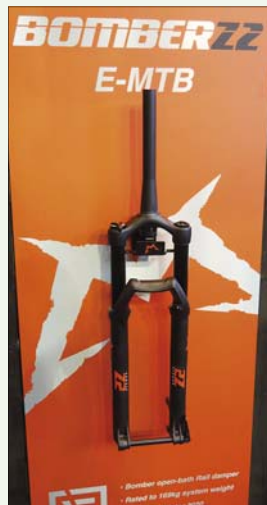
Těžký jezdec na horském elektrokole by určitě neměl spoléhat na obyčejnou vidlici s průměrem vnitřních nobou 30 nebo 32 mm a osou na rychloupínák. Silnější vnitřní noby (34–36 mm), pevná osa a tužší konstrukce rády e-bike specific vidlice nabídnou odolnost a delší životnost kluzných pouzder. Nový Bomber Z2 E-MTB je konstruován až pro 169 kg hmotnosti jezdce a kola.
