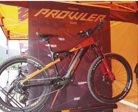
E-Enduro či E-All Mountain reflektující současné trendy, tedy pluskové sedmadvacítkové vlnu, devětdvacítku vpředu, nový výkonný Bosch Performance CX motor s větším převodníkem, plná integrace baterie v karbonovém rámu s boostovou osou a zadní 180/170mm. K tomu pružinový tlumič a elektronické bezdrátové řízení Sram nebo dálkové ovládaná teleskopická sedlovka.
