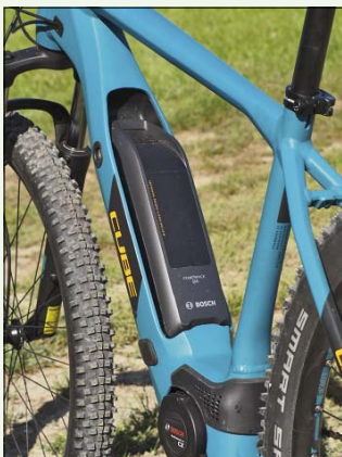
Středové pohony jsou stále kompaktnější a menší, aniž by to bylo na úkor výkonu. Toto řešení dostává maximum hmotnosti do těžiště kola, takže je nejlepší nejen z hlediska ovladatelnosti celku, ale i co se výkonu týká. Kratcíci moment se pohybuje v rozmezí 60–120 Nm, takže při správném nastavení na velké pastorky je vždy k dispozici hodně velká síla.
