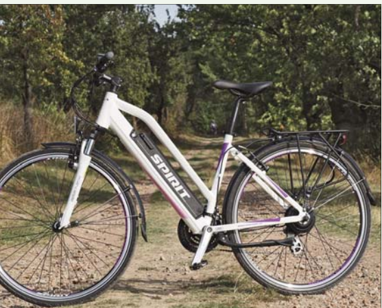
Dámský kros se semiintegrovanou baterií, umožňující snadné vyjmutí z rámu a zadním pohonem, typický obrázek kola pro univerzální využití, nabízející běžná krosová a trekingová kola. Často se ale baterie v rámu stavují omezením pro možnost instalace košíku na bidon a fáda majitelé elektrokol jej tak vozí na speciálním adaptéru na řidičích.
