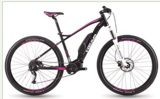
Pevný devětadvacíkový rám, středový pohon a baterie usazená na profilované spodní trubce. Asi nejpřipravenější řešení elektrokola pro většinu uživatelů, kteří chtějí jezdit na silnici a v lehkém terénu bez nějakých extrémů. Pevné osy nebo 34mm vnitřní noby u cenově dostupnějších vidlic jasně ukazují, že tyto detaily by zákazník neměl podceňovat, navýšují totiž odolnost elektrokola.
