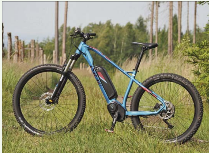
I v kategorii hardtailů lze ještě rozdělovat podle využití a více k trailovému ježdění mají stroje kombinující devětdvacítkové kolo vpředu a pluskové sedmadvacítkové v zadu. Ovladatelnost ve sjezdech je pak výrazně lepší a širší zadní pláště nabídnou kromě lepší trakce také nárost tlumení rázu, což je u elektrokola kvůli jejich hmotnosti vždy výhodou.
