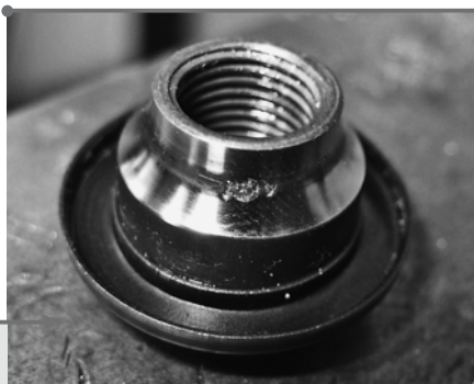
Poškození kuličkové dráhy na kónusu je zřetelné, tady nezbyvá než jej vyměnit.
