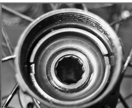
U zadního náboje je důležité dotažení ořechu, pravidelně vyjetá kuličková dráha nevdá, nesmí ale mít výraznější nerovnosti.
