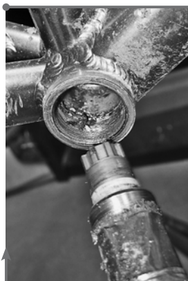
Ačkoliv je středové pouzdro pečlivě uzavřené miskami osy a závitem, přesto se dovnitř dostane spousta nečistot sedlovou trubkou.
