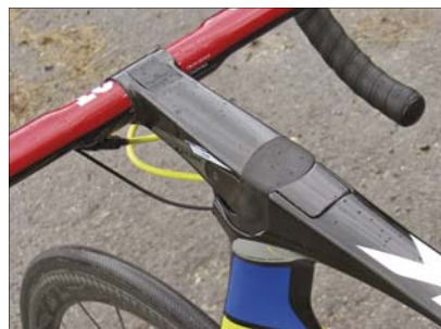
Integrace v podání značky Look aneb unikátní představec A-Stem používaný na silničních i MTB modelech.
