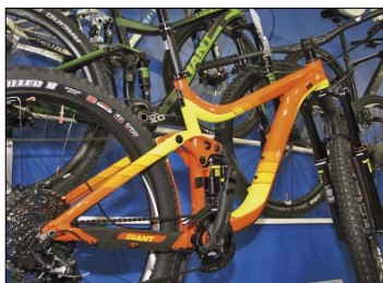
Expozice značek Giant a LIV sice nebyla vloženo obsáhlá, to nejdůležitější však nechybělo. V případě první jmenované byl tahákem třeba kompletní přepracovaný Reign 27.5" (na snímku), se 160mm zdvihem a osvědčeným závěsem Maestro. Značka LIV, zaměřená výhradně na dámy, ukázala například krásnou silničku na kotoučkových.
