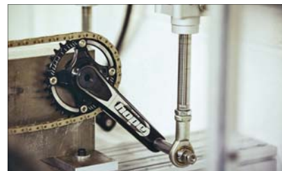
Zatěžkové testy klik probíhají jednak jako simulace šlapání a zaběr na jeden pedál, nebo i na oba současně, aby se nasimulovalo zatížení ve jízdě.
