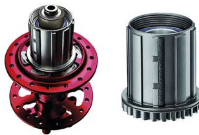
Detail náboje s odhaleným systémem šestice praporků aktivovaných při záběru naráží díky plechové podložce. Praporky se pak společně zakusnou do zubů na spodním vnějším okraji těla otečtu. Ten má ocelovou vložku kvůli ochraně proti zakusnutí pastorků do jeho těla.
