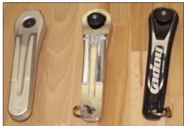
Od výkovku až k finální klice to není zase tak dlouhá cesta, ovšem vyžaduje to špičkové obráběcí stroje pracující s přesností tisíciny milimetru. Tato verze je ještě s polygonálním uchycením na osu.
