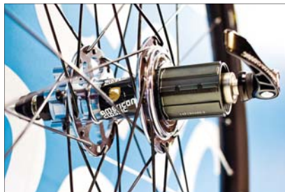
Typický design bikovních nábojů AC, vysoké přírby, šestice maximálně odlehčených otvorů pro uchycení kotevce a nápadné ložování. Variabilita pro různé typy os je pro celou MTB kolekci společná.
