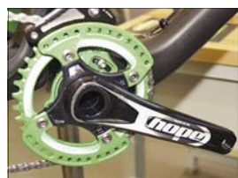
Původní verze vystavovaná ještě na podzim s polygonálním uchycením k ose se prostě neužila. Současná sériové provedení spoje na drážkovaný spoj a rozprávné provedení konců osy.
