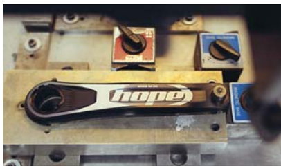
Již hotová klika s barevným povrchem se položí na desku a laserem se vypálí logo značky.
