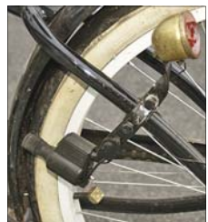
Klasické dynamo, jak jej zná většina z nás, tedy uchytené z boku na rám či vidlici, se sklápěcím mechanismem, zajišťující přitlak rotující plastové hlavice na bok pláště. Odpor a hluk jsou nedílnou součástí tohoto řešení.
