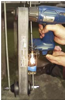
Testovaný typ HDS12 jsme prověřili v adaptéru s pomocí sekundárního pohonu (aku vrtáčka), který rozotáčel plášť náboje. Zárovka se rozsvítila už při minimálních otáčkách.
