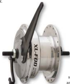
Dynamo Sturmey Archer v náboji kombinující ještě bubnovou brzdou. Tělo lanka na boku vyžaduje bezpečně zajistit vnější část brzdy dlouhou opěrkou k nose vidlice.
