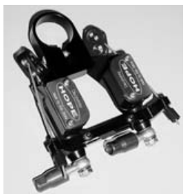
Systém pro převedení mechanického účinku lanka na hydrauliku.
