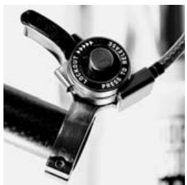
Externí uzavírání od Rock Shoxe. Na vrchní straně je umístěno kolečko, po jehož zmáčknutí se vidlice ihned vrací do funkčního režimu nastavení.
