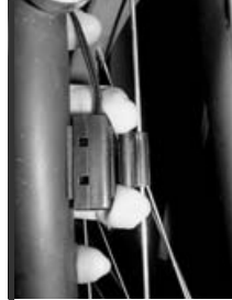
Snažte se vytvořit minimální mezeru mezi magnetem a snímačem.
