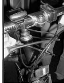
Vpravo computer (je lépe po ruce) a vlevo světlo (blíže středů vozovky). Tak to má být.
