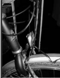
Uhlavně namotané vedení je pravidelné a není na bowdenu volné.
