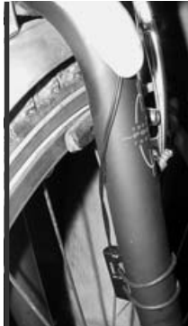
Nejlépe je vést vedení po zadní straně vidlice. Je tak chráněno před nečistotami.
