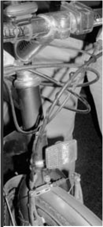
Správné tažení vedení tachometru po bowdenu přední brzdy.
